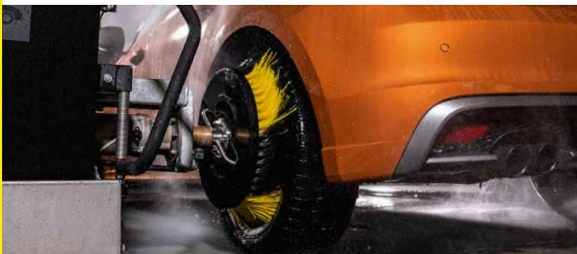
**Prelavaggio ad alta pressione.** L'alta pressione delle ruote, come l'alta pressione singola, ottimizza la pre-pulizia dei cerchi e della zona del passaruote. Se desiderate un prelavaggio ancora più efficiente dell'area laterale e della soglia, la combinazione di alta pressione laterale e alta pressione delle ruote a 16 bar o 60 bar è la risposta. Possiamo installare come opzionale l'alta pressione sulle ruote anche a 70 bar.
