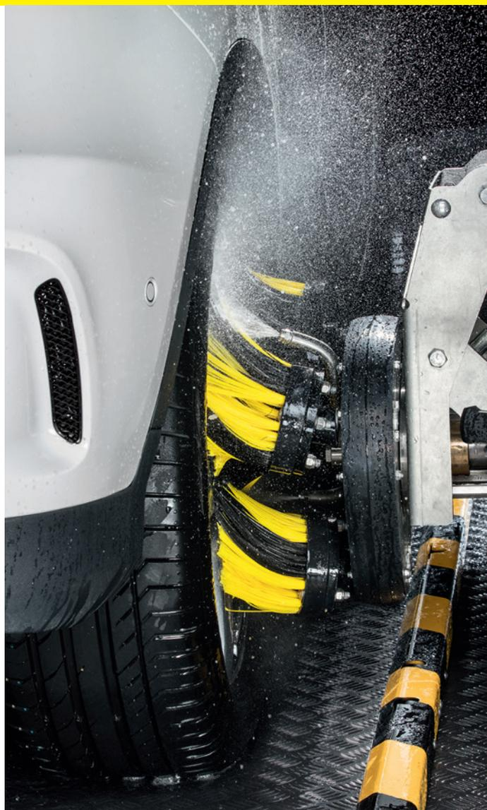
**K!Planet iQ** Grâce à notre installation de lavage des roues réglable en hauteur avec laveur de roues planétaire et haute pression intégrée, vous bénéficiez d'un nettoyage optimal des jantes. Dans cet objectif, nous avons doté notre K!Planet iQ d'un système de nettoyage des passages de roue intégré.
