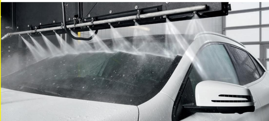
**Haute pression toit sur bras frontal** Le dispositif à haute pression monté directement sur la brosse de toit s'associe au lavage à la brosse pour un nettoyage en un seul passage. Notre recommandation pour les programmes de lavage rapides.
