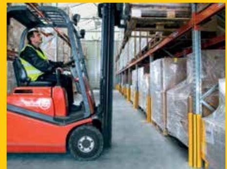
Schutz von gefährdeten Anprallpunkten an Regalbeinen in einem Ausgangslager durch den Regalbeinschutz RackGuard.
