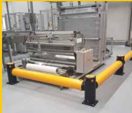
iFlex Verkehrsbarriere Standard zum Schutz von Maschinen in einer Verpackungsanlage.
